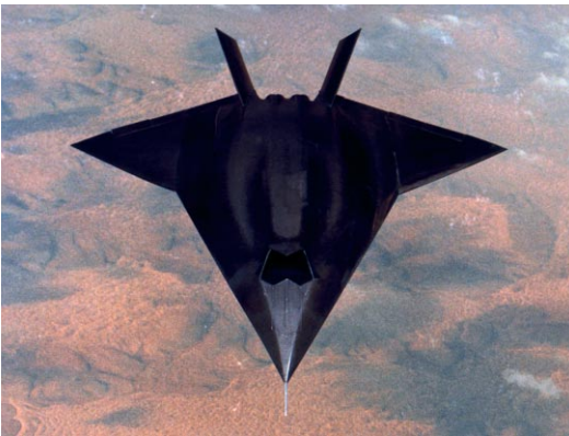
Le Petit duc est un drone (petit avion télécommandé) que développe Dassault Aviation. C'est un appareil furtif: sa forme et ses matériaux sont choisis de manière à ce qu'il soit difficile à détecter par les ondes radar. Ce choix s'effectue sur la base de calculs compliqués portant sur la propagation d'ondes; dans certains cas, la précision de tels calculs laisse à désirer et fait l'objet de recherches soutenues (Cliché Dassault Aviation).
