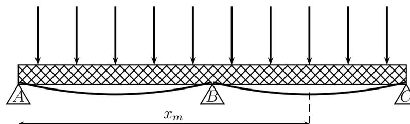
On démontre que le point situé entre  $B$  et  $C$  où la déformation (la flèche) est maximum, a une abscisse  $x_m$  qui est solution de l'équation :
