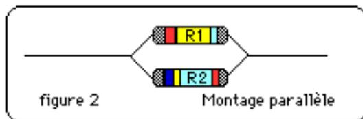
On a mesuré au moyen d'un ohmmètre la résistance des circuits dans les deux cas de figure. Dans le premier cas (montage série), on a trouvé  $1250 \Omega$  et dans le second (montage parallèle)  $288 \Omega$ .
