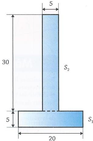
On cherche à déterminer le centre d'inertie  $G$  de la section de ce profilé.
